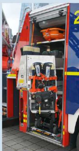
Im G2 lagern die beiden Atemschutzgeräte auf einem speziellen Auszug. Darunter wird ein Belüftungsgerät, darüber die Schleifkorbtrage mitgeführt.
