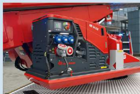
Auf einer Plattform am Drehschemel steht der 14-kVA-Stromerzeuger von Rosenbauer.
