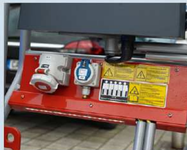
Im Korb sind verschiedene Stromanschlüsse angebracht.
