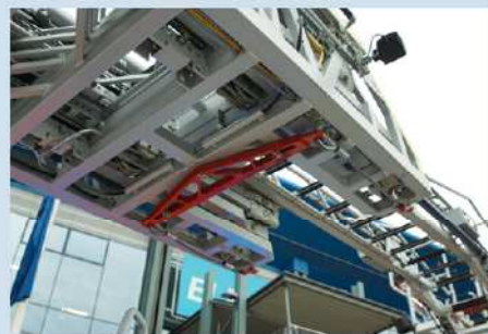
Mit dieser Einhängeöse am 4. Leiterteil können maximal 1,5 Tonnen angehoben werden.
