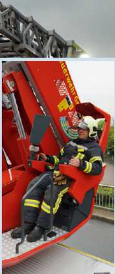
Der Hauptbedienstand am Drehgestell ist mit einem Weterschutzdach ausgestattet. Der Sitz ist so konstruiert, dass der Bediener den Korb immer optimal im Blick hat.
