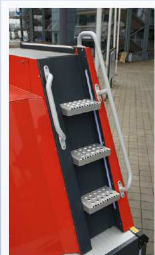
Alle Aufstiege am Fahrzeug sind mit LED-Lichtbändern versehen.
