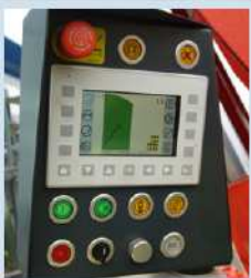
Auf den ersten Blick sieht der Maschinist am Display des Bedienstandes, ob sich der Korb im grünen Bereich befindet.
