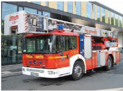
Auf Mercedes Eonic mit Hinterachs-zusatzlenkung (Bild unten) war die vorherige Drehleiter-Generation in Gelsenkirchen aufgebaut. Fotos (2): Florian-gelsenkirchen.de
