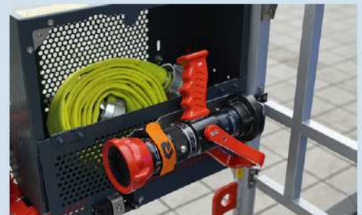
Als Schnellangriff im Korb dient ein Hohlstrahlrohr mit einem 10 Meter langen Anschlusschlauch.
