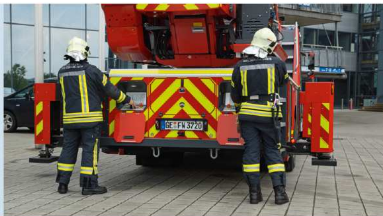
Übungseinsatz an der Veltins-Arena auf Schalke. Die Abstützungen werden ausgefahren.
