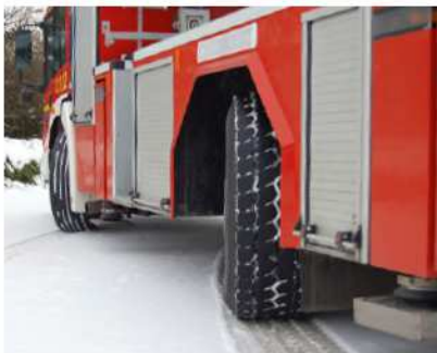
Auf Mercedes Eonic mit Hinterachs-zusatzlenkung (Bild unten) war die vorherige Drehleiter-Generation in Gelsenkirchen aufgebaut. Fotos (2): Florian-gelsenkirchen.de
